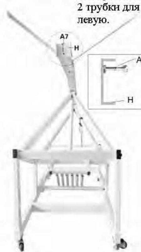
Вставьте винт (A7) в отверстие на передней части основной стойки (H) как показано, затяните винт (A7). Данный винт предназначен для регулировки щита в вертикальном положении.
